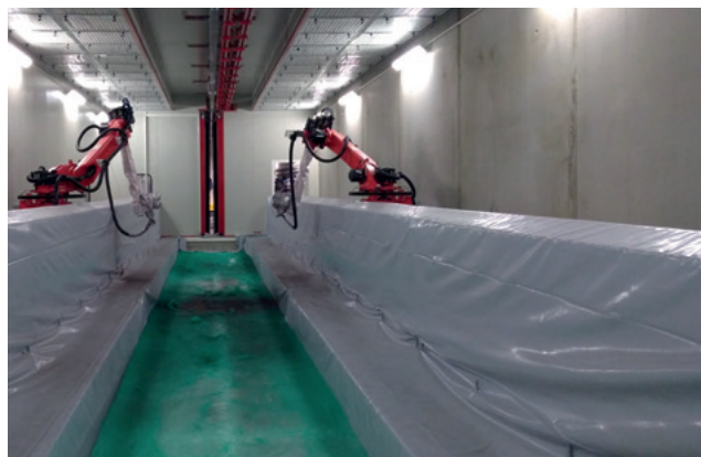
Die beiden Roboterarme veredeln bis zu 20 m lange und 3,2 m breite BSP-Elemente
