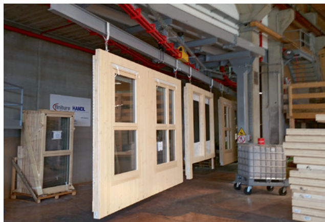
Für das HoHo werden von Stall im Mölltal aus Wände mit fertigveredelten Oberflächen samt eingebauten Fenstern montagefertig geliefert
