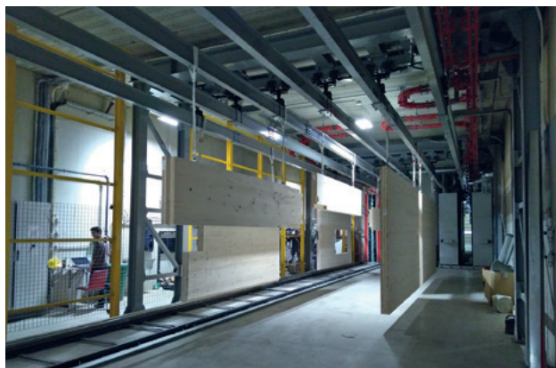
Im Eingangspuffer können mehrere Elemente gleichzeitig vorbereitet werden
