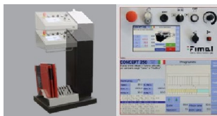
Höhenverstellbares Bedienpult mit Touchscreen und Schnittplanerstellung
