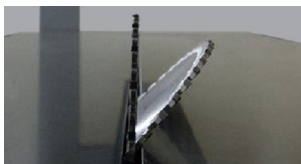
46° schwenkbare Sägeaggregat mit Vorritzfunktion
