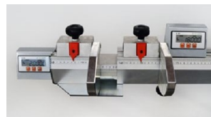
Längenanschlag mit digitalen Anzeigen
