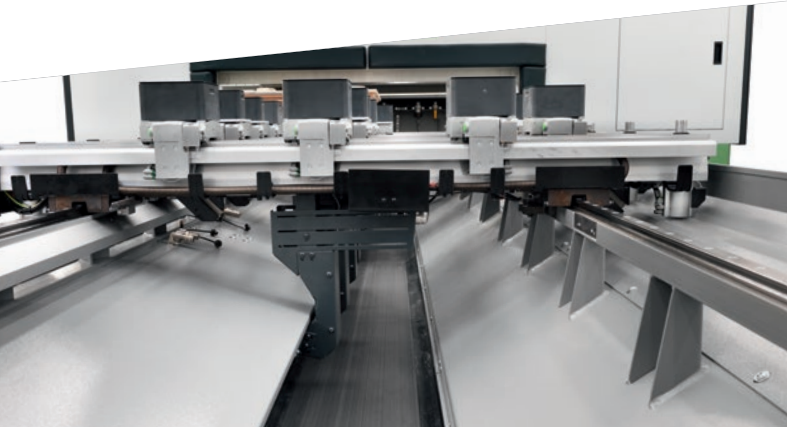
Motorisiertes Förderband für die Spanabfuhr.
