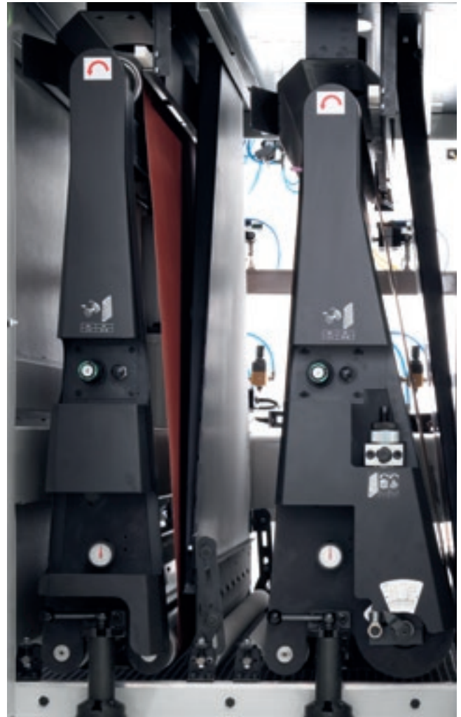
Kombinierte Walzen/Schleifschuh-Ausführung, Schleifschuh.
