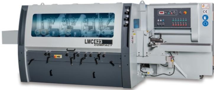
Von der Erweiterung auf bis zu 9 Spindeln und der Anordnung bis hin zu höheren Motorenleistungen und hochmodernen Steuerungspaneelen mit der Möglichkeit der Abspeicherung von 200 Programmen.
